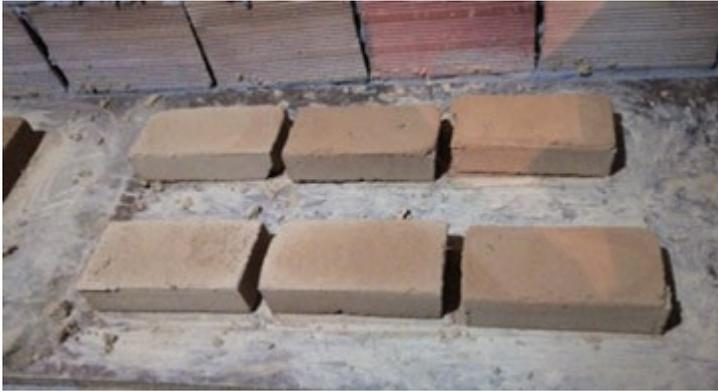
**Figura 10.** Desmoldeado de ladrillo, secado final
