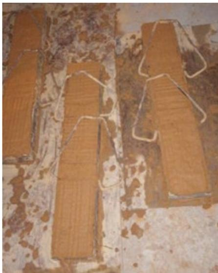
**Figura 13.** Moldeado de ladrillos, mezcla 1 húmeda
