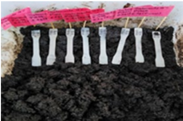
Figura 4. Siembra de probetas al 15 % de almidón en el compostaje Fuente: elaboración propia.
