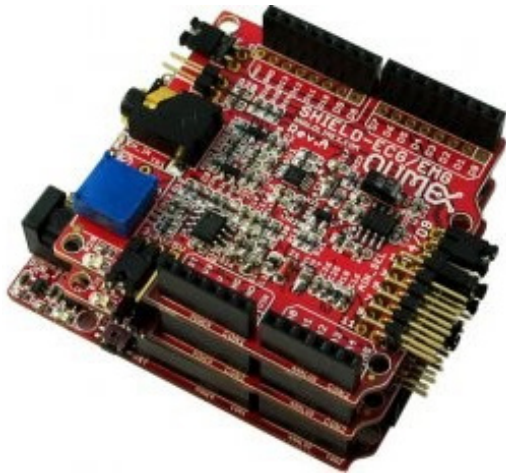
Figura 4a. Tarjeta de adquisición Olimex Shield EKG-EMG Arduino. Fuente: Olimex, 2017.
