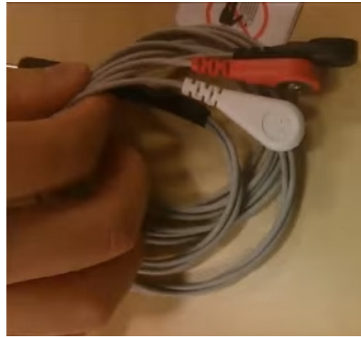
Figura 4b. Cable con tres derivaciones para electrodos tipo botón. Fuente: Chou, 2016.
