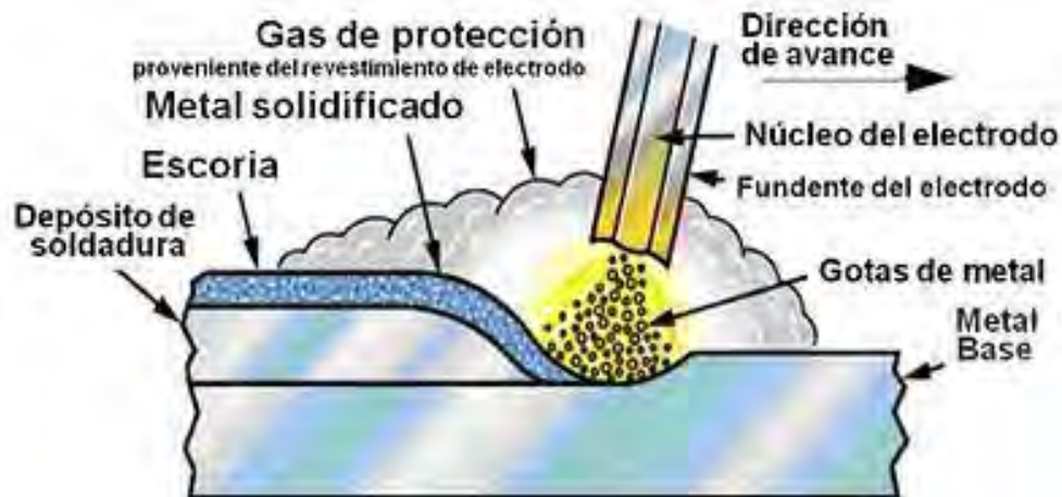
Ilustración 26, esquema de arco con electrodo revestido ( www.decoranatural.com/ )
