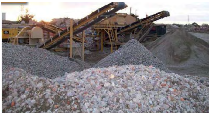
Almacenamiento de agregados reciclados ya clasificados.
