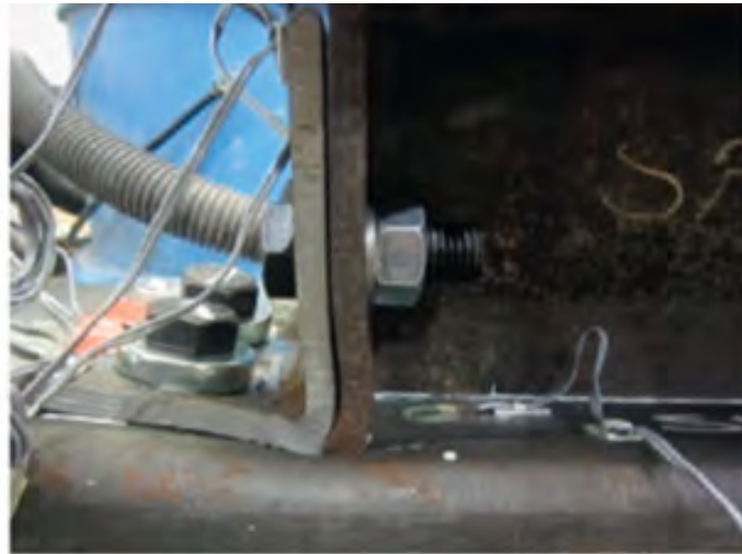
Figura 6. Deformaciones principales en conexiones bajo cargas a tensión [8]
