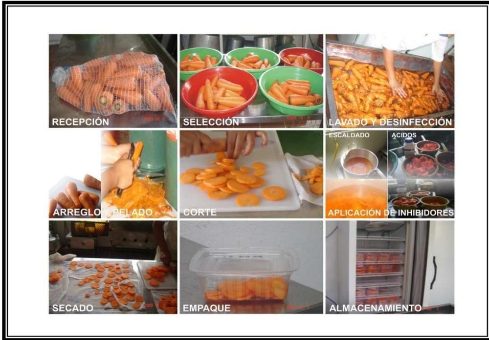
Figura 8. Etapas de proceso de la zanahoria *Chantenay*
