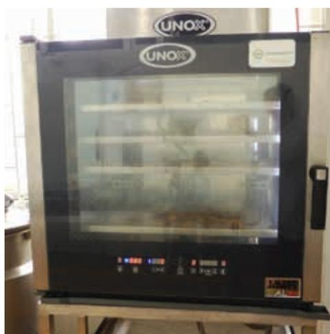
Figura 3. Horno de convección para procesos de secado por aire caliente
