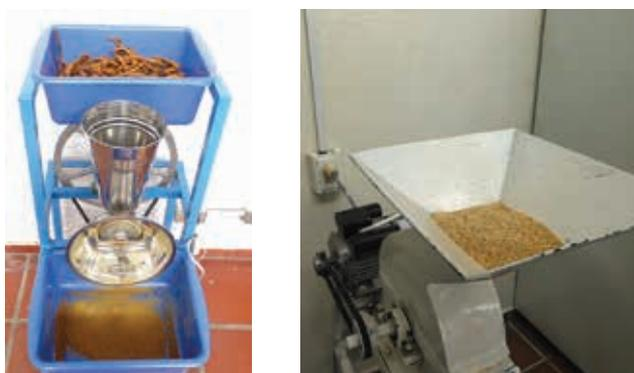
**Figura 1.** Molino de discos con mango deshidratado (izquierda) y molino de martillos con quinua (derecha)
