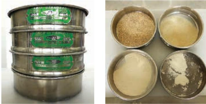
**Figura 2.** Juego de cuatro tamices para separar quinua procesada en molino de martillos (izquierda) y producto separado por diferencia de tamaño (derecha)
